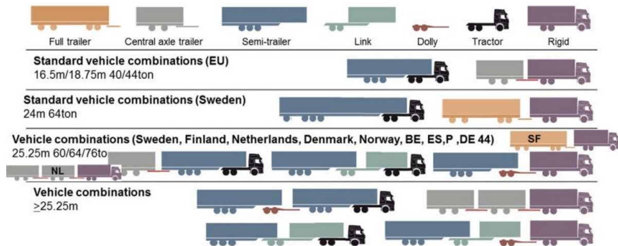
Figur 1 Komponenter och konfigurationer av standard och HCT-fordon
