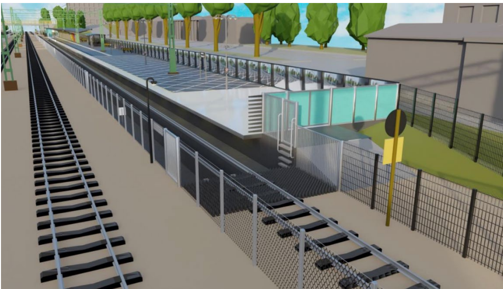
Figur 6. Exempel på åtgärder vid stationsområde från Modell över den Suicid-och personpåkörningsanpassade järnvägen. 9 De mest prioriterade åtgärderna är att området runt plattform och spår är intrångssäkert (här med stängsel och glasbarriär), samt att begränsa enkel tillgång till de intilliggande spåren där tåg passerar stationerna i höga farter (med "spärrstaket"). Bild reproducerad i sin helhet från Fredin-Knutzén & Hadlaczký (2024) 17
